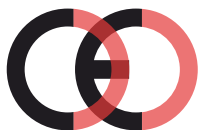
Virheellinen CE-merkki (liian lähellä)
